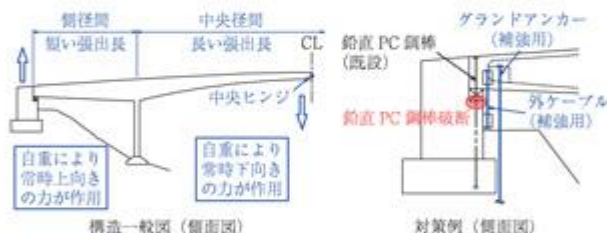
図-6 ダブルックバンド構造形式概念図
