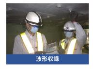
AEセンサを取り付けた既設のアンカーボルトを鋼球で打撃し、 発生した弾性波を収録、解析することによって コンクリートの変状状況を把握することができます。
