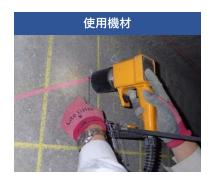
鋼球を用いて発生させた弾性波を収録・解析し、 反射波の周波数ピークからグラウト充填度を推測します。
